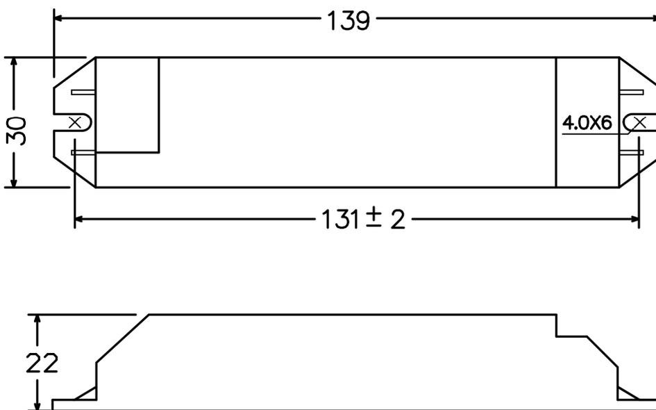
5.2、电池尺寸 (A1 型 / 连接线长: 150-170 mm)
